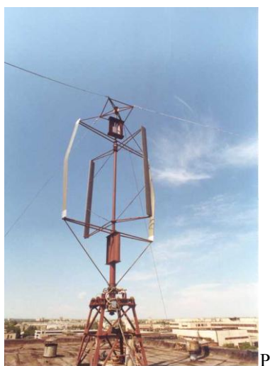
Рисунок 7. Би-Дарье (7 кВт) с противоположным вращением валов (г. Уральск).
