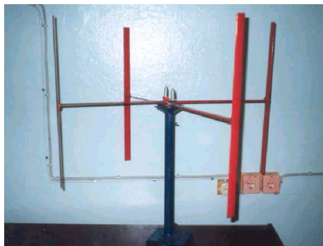
Рисунок 3. Принципиальная схема Би-Дарье с прямыми лопастями (одностороннее
